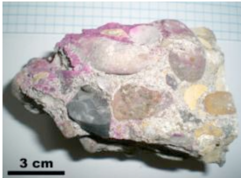
Fig. 2 – Aggregato arrotondato e liscio nel cemento degli anni '50 (materiale di fiume) - Round and smoothed aggregate in 50's concrete
