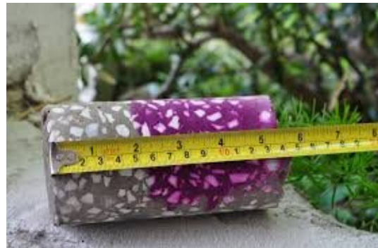
Fig.3 – Fenolftaleina che mostra il livello di carbonatazione nel calcestruzzo. Il calcestruzzo carbonatato è bianco - Phenolphthalein showing the level of carbonation in concrete. The carbonated concrete is white
